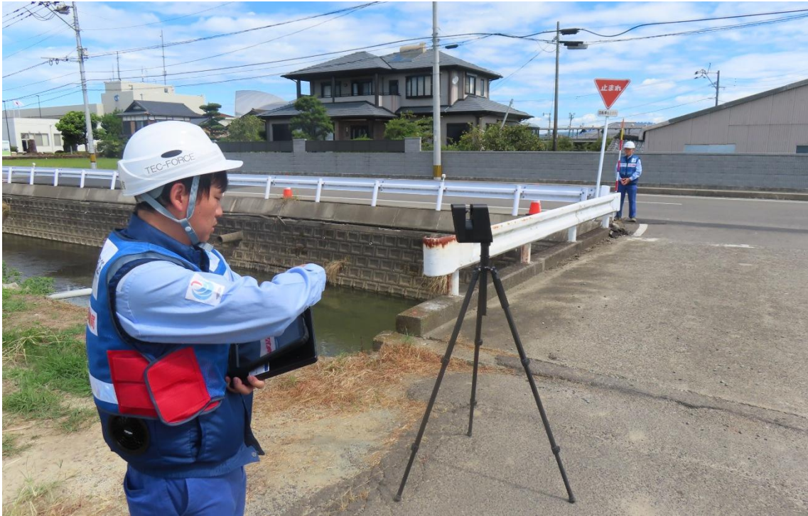
レーザスキャナを活用して被災状況を計測する計測員
