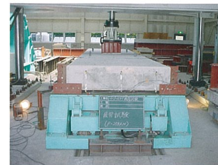
繰り返し荷重載荷(200万回)試験状況
